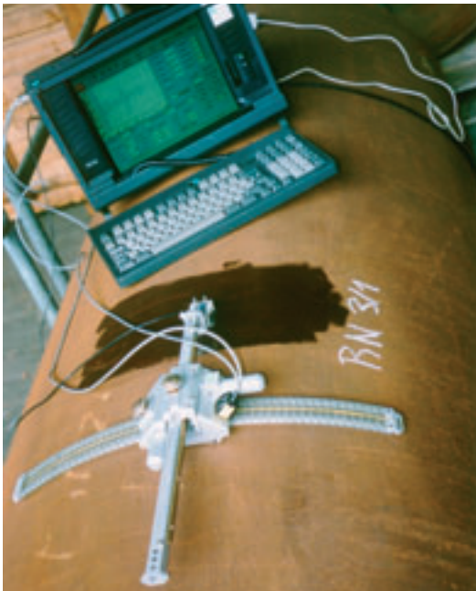
US-System PCUS11 mit Handmanipulator
